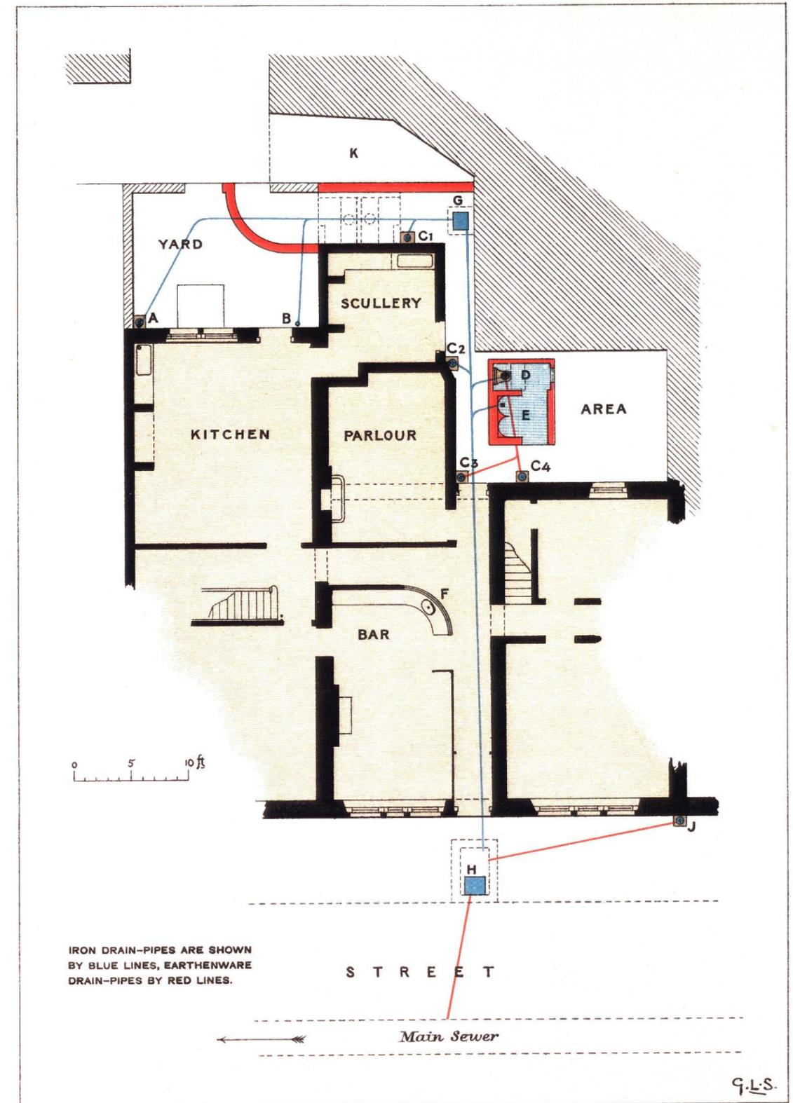
IRON DRAIN-PIPES ARE SHOWN BY BLUE LINES, EARTHENWARE DRAIN-PIPES BY RED LINES.
